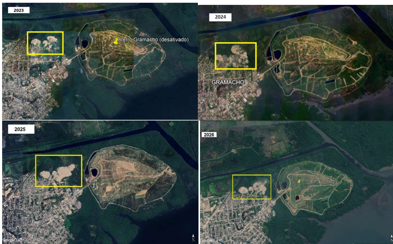
Figura 10: Histórico de imagens de satélite destacando a ocorrência e expansão de lixões clandestinos (retângulo amarelo) e irregulares próximos ao aterro controlado desativado em Jardim Gramacho, Duque de Caxias/RJ. Fonte: Google Earth.
